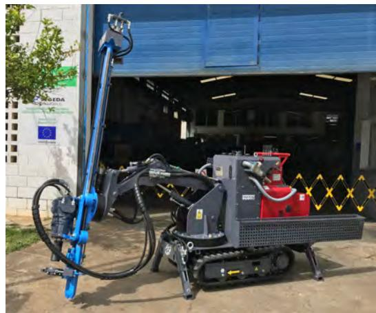
Este equipo perforador está diseñado para perforar con martillo en fondo de 3" a 6", empleándose principalmente para micropilotes. Por sus reducidas dimensiones y su gran versatilidad, es muy adecuado para ser utilizado en sótanos y espacios pequeños. Dicho equipo puede ser neumático o hidráulico y monta torre oscilante, adelante-atrás de 45° de movilidad. Se hacen otras versiones adaptadas siempre a las necesidades del cliente.
