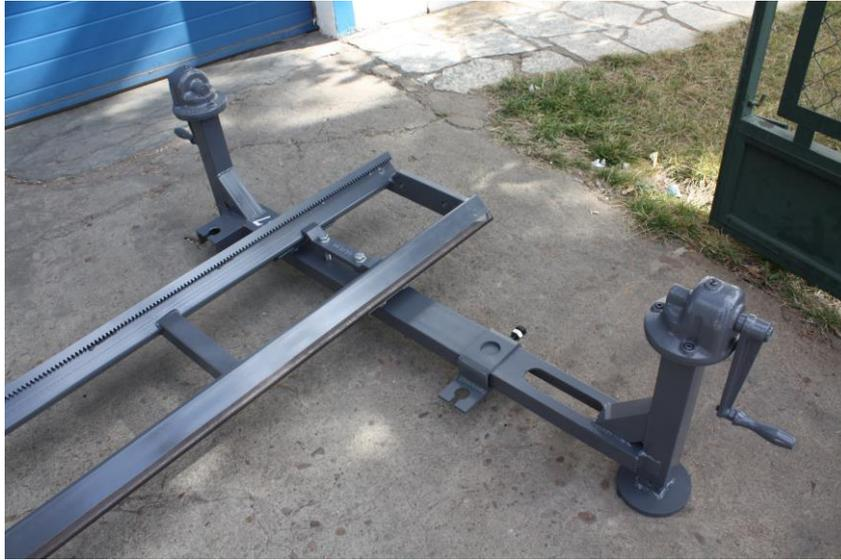
Detalle de pata de gato con manivelas de elevación
